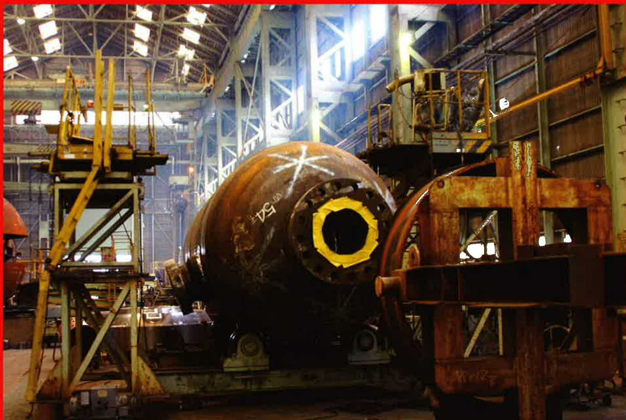
日立造船メカニカル 舞鶴工場の圧力容器製作
